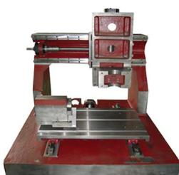
Eine massive Guss-Unterkonstruktion, schwere LM Kugelumlauf Führungen, sehr genaue und große Kugelrollspindel, A&B Achsen mit HarmonicDrive Getriebe und max. LMF Abstand garantieren lange Lebensdauer. Starke Antriebssysteme von Yaskawa und eine hochdynamische CNC Steuerung garantieren homogene und schnelle Bewegungen aller Achsen.
